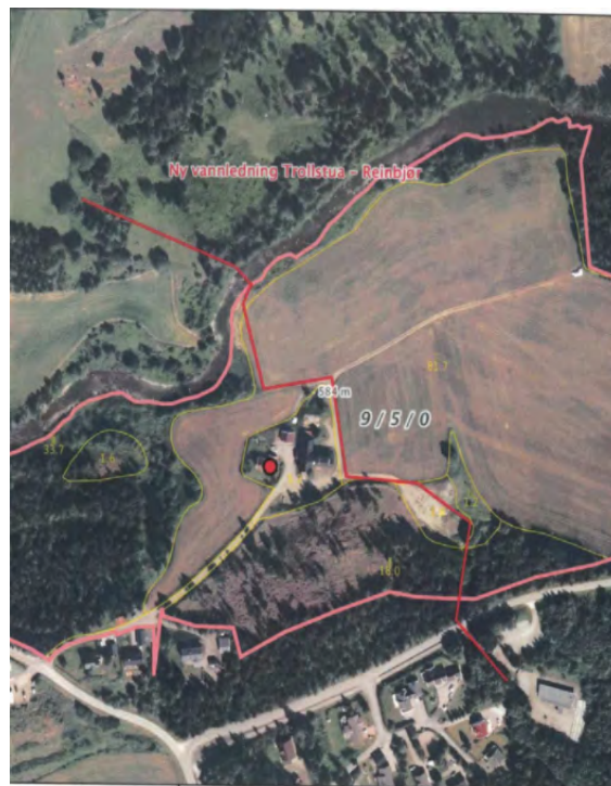
Figur 1: Viser planlagt ledningstrase fra Trollestua og fram til eksisterende ledningsnett ved Reinbjør.
